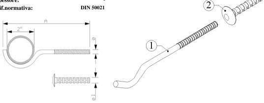
Componente Classe materiale Dimensioni 1- Mensola radiatore tubolare FE360 ø8,5x250
