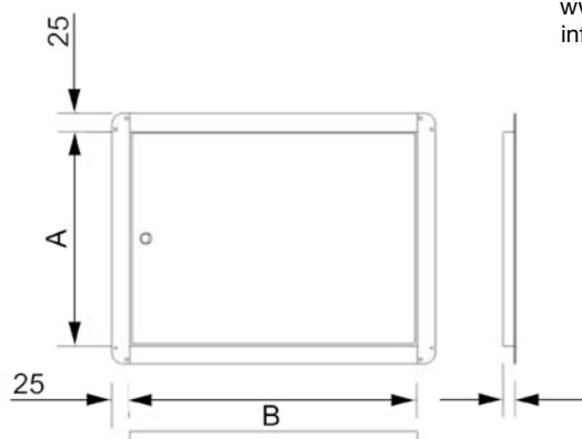
Sportello da incasso per ispezione collettore in lamiera preverniciata bianca RAL9010, con telaio a battente, serratura con chiave a quadrello; chiave maschio.
