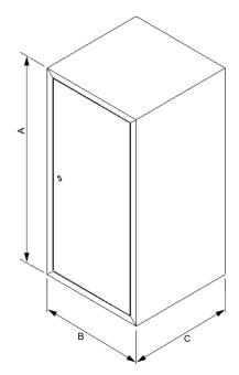
Vano di protezione per bombole in kit di montaggio. Realizzato in acciaio verniciato bianco.
